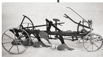
Плуг с индивидуальными предохранителями корпусов для автоматического возвращения в рабочее положение
